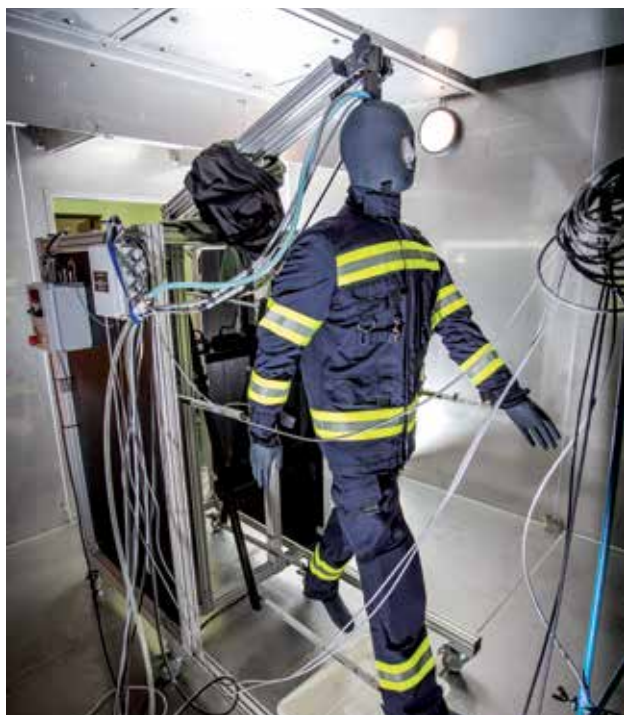
Badanie właściwości użytkowych odzieży ochronnej dla strażaków przy użyciu manekina termicznego
