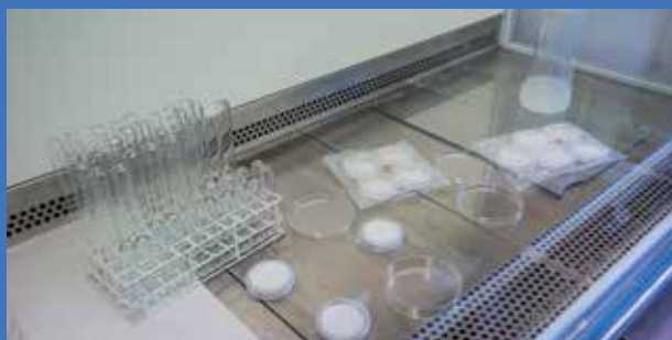
Radiacyjnie sterylizowane rusztowania 3D ze zmodyfikowanego kolagenu do badań neurobiologicznych i oceny ich właściwości fizykochemicznych
